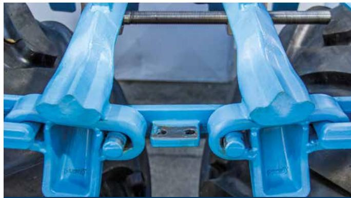
9 Continuer la tension jusqu'à ce que la serrure pewag bluetrack puisse être introduite et la fixer au côté intérieur.
