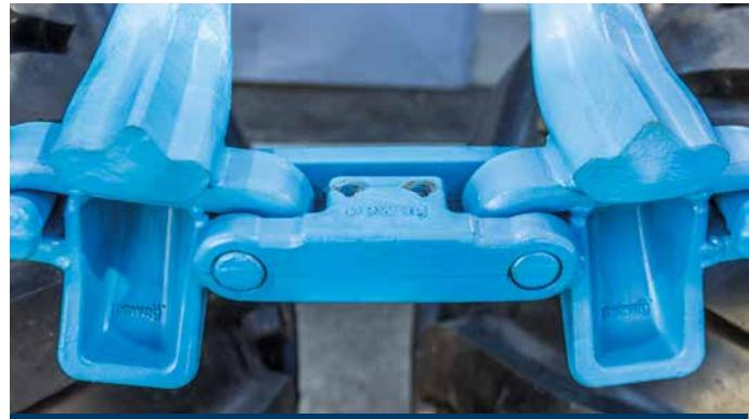
10 Kiinnitä pewag bluetrack telaliitin paikalleen vastakkappaleen avulla.
