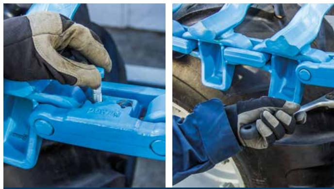
11 Установите винты сверху и затяните их само фиксирующимися гайкам снизу при помощи ключа или трещотки (22 мм).
