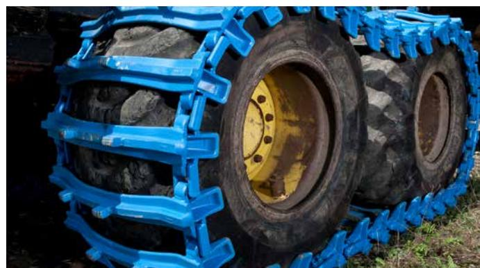
12 Nyní odstraňte pewag bluetrack montážní nástroj. Optimální napnutí je dosaženo v případě, že prověšní pásu mezi koly je nižší než 50 mm. V případě, že je průhyb větší než 50 mm, upravte pewag bluetrack pomocí pewag bluetrack montážních spojek (pomocí spojek různých délek) nebo odeberte jeden přičník (jednu lamelu).
