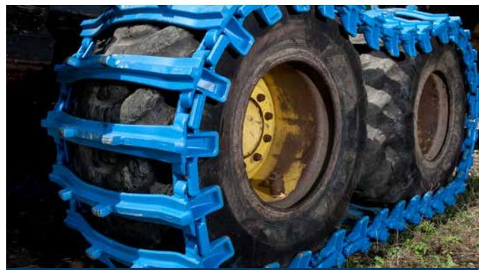
12 Теперь снимите стяжку. Оптимальное натяжение гусеницы было достигнуто если провисание сегментов между колесами не превышает 50 мм. Если же провисание составляет более 50 мм, отрегулируйте уровень натяжения при помощи замков pewag bluetrack разной длины и / или съемных сегментов.
