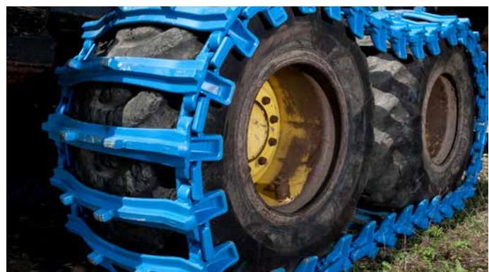
12 Enlever maintenant l'outil de montage pewag bluetrack. La tension optimale est atteinte quand la flèche de la chenille entre les pneus ne dépasse pas les 50 mm. Si la flèche est plus importante merci d'adapter la chenille pewag bluetrack en utilisant les serrures pewag bluetrack (de différente longueur) et/ou les barres à démonter.
