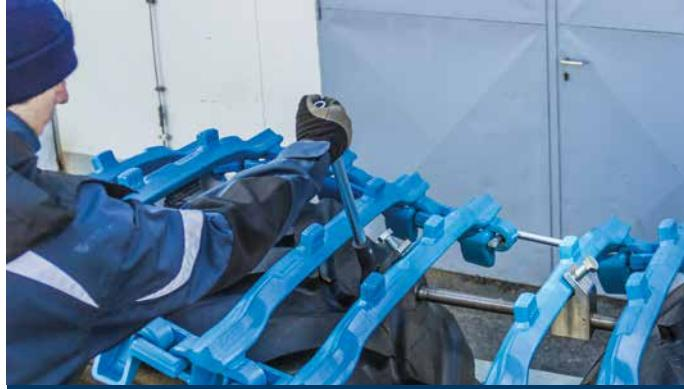
7 Nyní použijte běžný 3/4" napínač pro napnutí pewag bluetrack.
