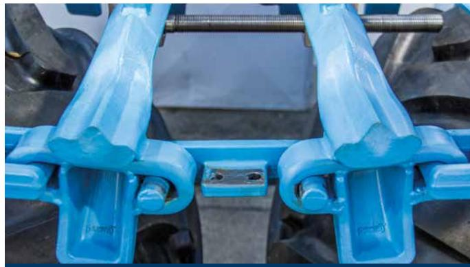
9 Продолжайте стягивать сегменты пока не станет возможной установка замка изнутри, после чего, установите сначала внутреннюю его часть, а после внешнюю.
