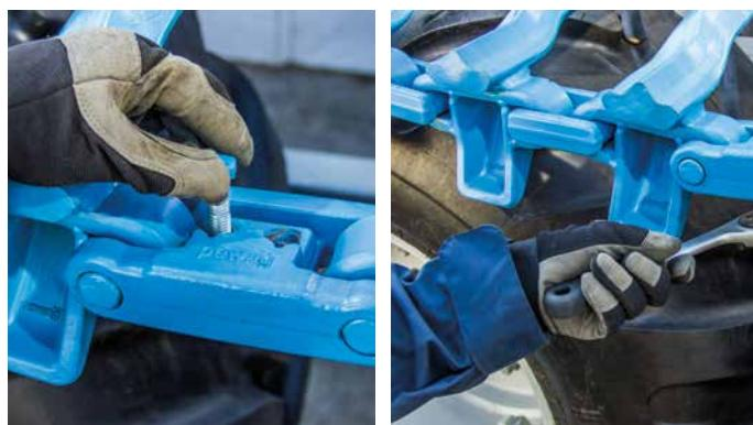
11 Rajouter les vis en haut et fermer par le dessous à l'aide d'écrous autobloquants. Les serrer par un cliquet ou une vis (taille 22 mm) pour que la serrure pewag bluetrack ne puisse pas se relâcher.
